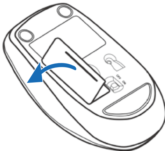
Figura 3. Retirar la tapa de la base
